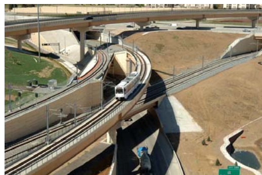
Figura 1—Trem de passageiros do sistema de Transporte Urbano via Trens Elétricos de Denver na interligação I-25/I-225. Sua estrutura é leve e compacta, propiciando sua operação nas ruas de cidades congestionadas e nos corredores urbanos estreitos com diversas paradas. O sistema de trens eletrificados foi introduzido na região em 1994.
