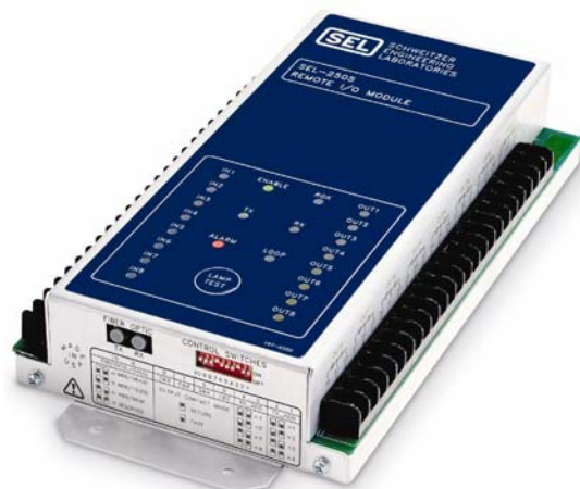
Figura 3—A flexibilidade do Módulo Remoto de I/Os SEL-2505 propicia que os engenheiros efetuem o upgrade do projeto com esquema de transfer-trip dos sistemas elétricos usando um dispositivo classificado para uso em concessionárias com maior confiabilidade, compactidade e comunicações avançadas. Usando a comunicação MIRRORED BITS entre os dispositivos, os dados são tipicamente transmitidos a uma taxa de 11 ms. Outra vantagem é a possibilidade de substituição da fiação de controle externa aos painéis por cabos de fibra óptica, reduzindo a exposição ao terra DC.
