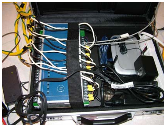
Figura 11. Dispositivo para aquisição de dados usado nos testes com simulação de faltas de alta impedância
